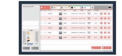
プリンタ本体の大型パネルで操作可能。造形スタートの操作や、プリント履歴の確認、ノズルチェックやクリーニングなどの設定・操作ができます。
