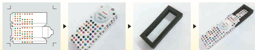
トンボ作成機能で4点のトンボを作成し、プリントする CFL-605RTでカットしてパッケージを作成 発泡材をCFL-605RTでカットして緩衝材を作成 製品・パッケージ・緩衝材を組み合わせて完成!
