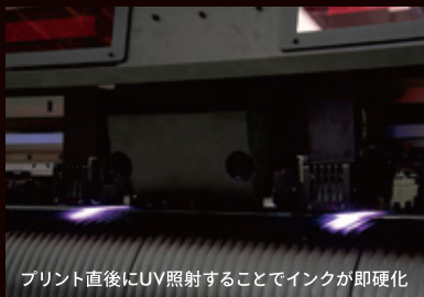
プリント直後にUV照射することでインクが即硬化
