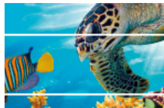
隙間 / 白すじ (フィード量過多)
