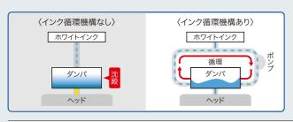
MCT Version2 (Mimaki Circulation Technology Version2) ダンパ\*\*内のインクを含めたインク経路全体を循環させることでホ ワイトインクの吐出が安定し、頻繁なノズルクリーニングによる無 駄なインク廃棄を減少します。
