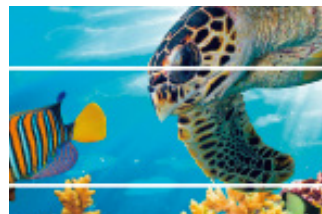
隙間 / 白すじ (フィード量過多)
