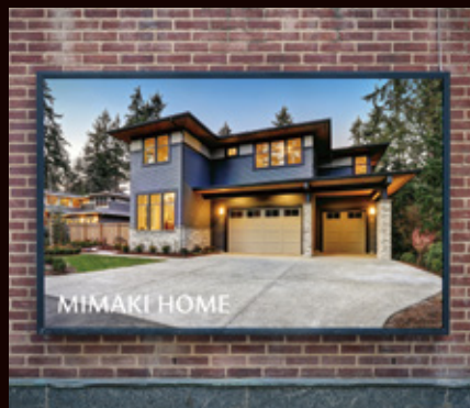
【バックライトOFF】 日中の看板のイメージ。4層目のカラー層のみ見えている。
