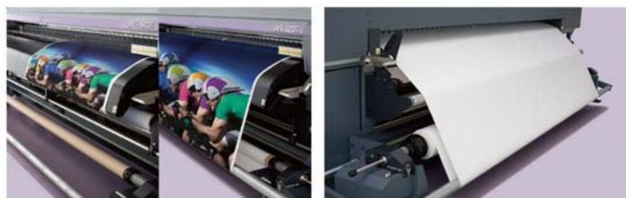
小巻き取り装置 重量巻き取り装置 繰り出し装置
