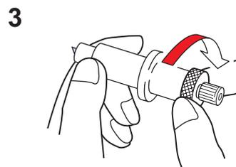
$$\text{刃先の出し量} = \frac{(\text{フィルムの厚さ} + \text{ベースの紙の厚さ}) * 1}{2}$$
