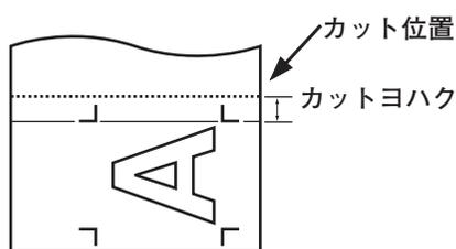
トンボ連続読み取りコピー時には、TP2 から次のトンボの TP1 の距離が計測時にわかっているので、TP1 と TP2 の中間を切り離します。
