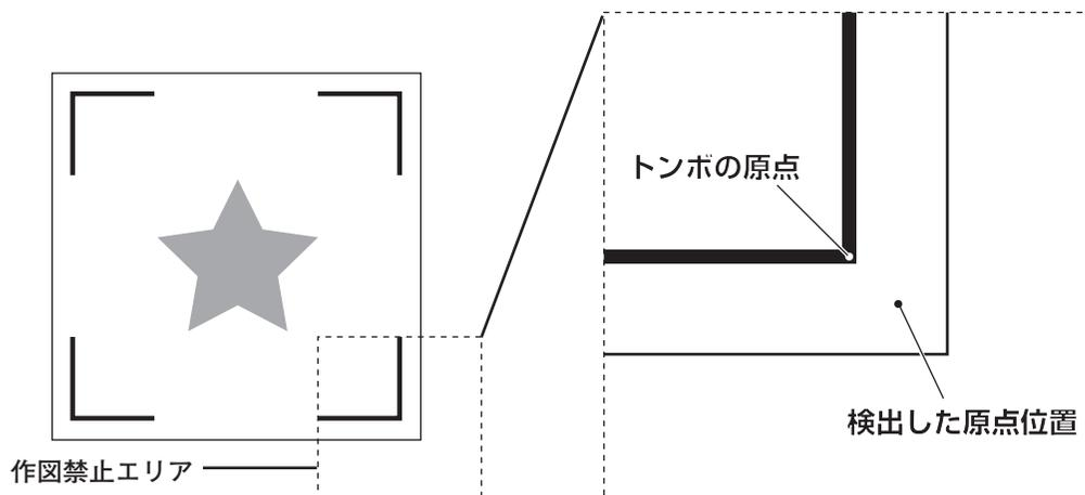
**トンボ原点誤検出の例 2:** トンボの間隔 (TP2とTP1、TP4とTP2) がトンボの長さ以上あいていない (トンボ形状がタイプ 2 の場合)
