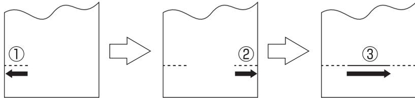
2ステップの場合、左端 10cm をカットした後、右側を切り離します。
