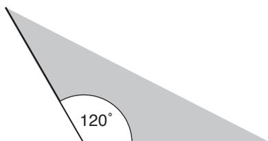
これは角をカットする際、シートがめくれないように自動的に低いカット圧力(約 5g)でカットします。カット圧力が低いため、刃先が進行方向にスムーズに回転せず、切り残しができる場合があります。このような場合は、角をカットする際の圧力を上げるための設定を行います。
