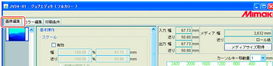
(2) 「印刷条件」タブをクリックし、JV34 にセットしているインクに合わせたプロフィールを選択する
