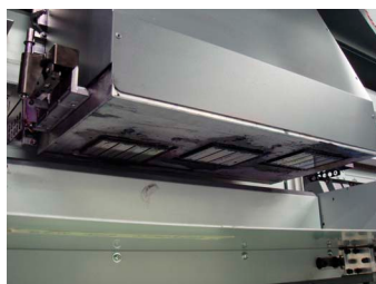
クリーンスティックを使い、スライダ下面及びヘッド周辺の清掃を行う
