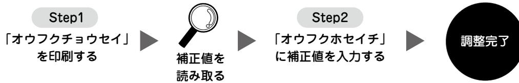
各プリントヘッドの往復位置を調整します。「オウフク マニュアル」の印刷結果をもとに補正値を入力します。
