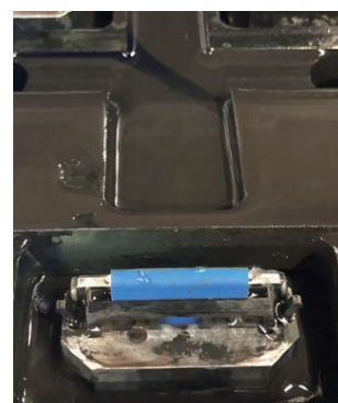
ポンプ出力が弱過ぎる状態
