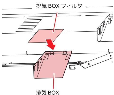
**3 排気 BOX フィルタ、または排気 BOX を新しいものに取り換える**
