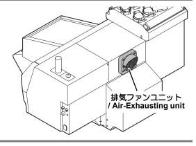
**1** ファンフィルターカバーを取り外す (ツメ x2) / Remove the fan filter cover. (Hook x2)
