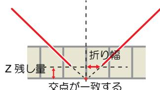
さらにVカットツールの取り付け角度により、「Z 残し量」と「折り幅」の設定を変更します。
