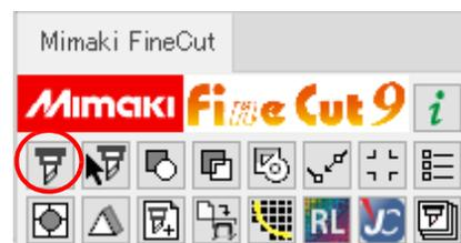
**3** (回転ボタン) をクリックして、プロッターにセットした画像と、FineCutに表示された画像の向きを合わせます。
