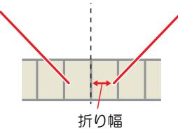
出力条件設定の V カット折り幅のチェックをオフにすると、Z 残し量と V カットツールの取り付け角度から適切な折り幅を計算してカットします。
