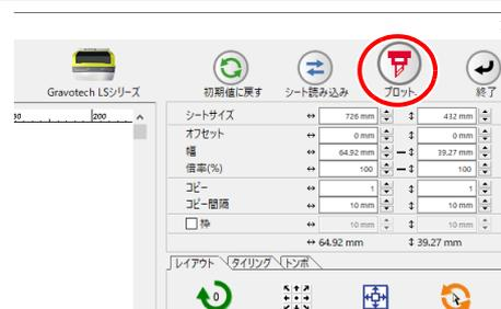
4 [プロッタ出力]画面でカット条件を選択して [プロット] ボタンをクリックします。
