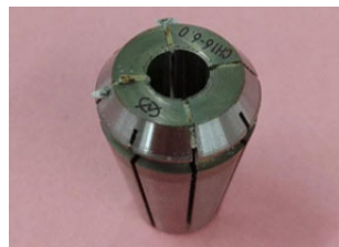
チャックの溝にゴミが溜まった状態
