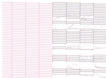
ノズル詰まり
