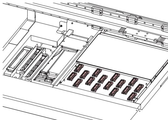
NCU（Nozzle Check Unit）は、ノズル詰まりがあるかどうかを自動でチェックするユニットです。各種機能を設定すれば、プリントヘッドの自動クリーニングや別のノズルを使ってプリントさせることができます。☞「[プリント前ノズルチェックについて](#)」（P.112）
