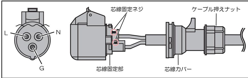
(1) ケーブルの末端を図に示したように処理してください。
