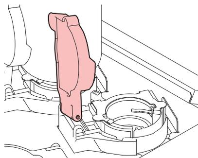
2 手順1で挿し込んだ穴の方に押しながら、もう一方の突起を挿し込む。
