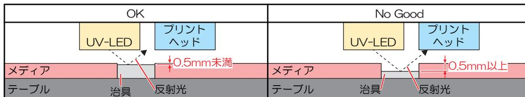
(2) 端部に曲面があるフライングディスクなどにプリントする場合は、曲面を覆ってください。曲面にUV-LEDの光があたると、反射光を多く拡散してしまうおそれがあります。
