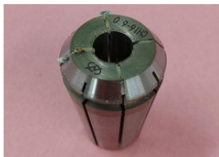
チャックの溝にゴミが溜まった状態
