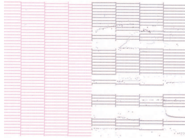
ノズル詰まり
