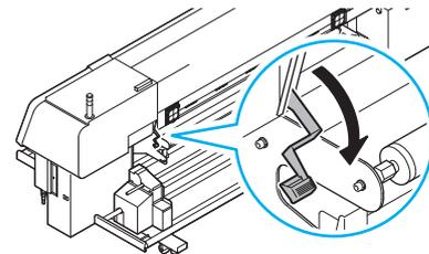
**11** 装置前面に回り、布の先端を手で押さえながらクランプレバーを上げ、布を引き出す
