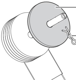
カウンターウェイトを取り付けたあと、ウェイトが落ちないようにクリップ止めしてください。クリップは、カウンターウェイト取り付け棒に付いている穴に差し込んでください。
