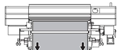
**14** 装置背面の繰出装置のスイッチを操作して、巻取側の布の先端を巻取装置にセットした紙管に貼り付けられる位置まで巻き戻す
