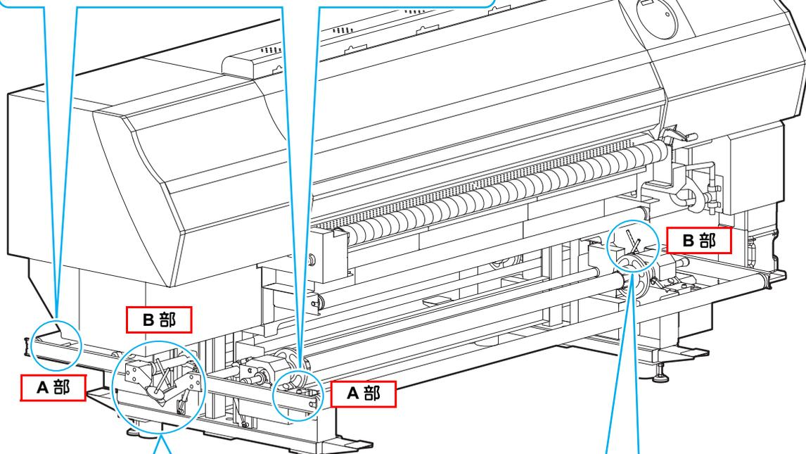
巻取テンションバーの重量を軽くしたいときは、装置の後側にウェイトを取り付けます。また、繰出テンションバーの重量を軽くしたいときは、装置の後側にウェイトを取り付けます。
