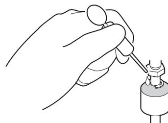
(2) フロートを上下に動かし、洗浄液をなじませる
