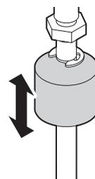
(3) フロートが正常に動くようになったら、フロートや管に付着した洗浄液をウェス等で拭き取る
