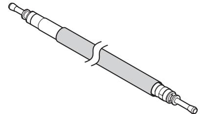
(3) 左右のロールホルダーを紙管に押し込み、ロールホルダーのハンドルを時計方向に回す
