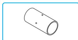
ネジ穴が上を向く位置にネジ止めする
