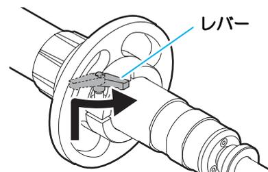
(2) レバーを一旦離し、図の方向に回して締める
