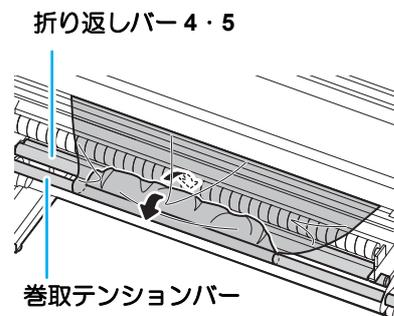
**13** 布の先端が床に着く程度まで引き出し、シワなどを取る
