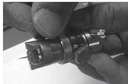
**5** ダイアルを回して刃先の出し量を調整します
