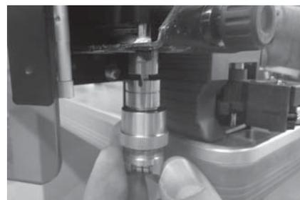
**9** cutterホルダーを突き当ててストッパーネジを締め付けます
