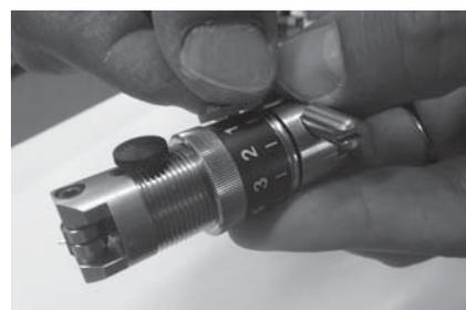
**7** Bユニットのピンをタンジェンシャルカッターの溝に合うように挿入します。
