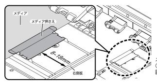
メディア押さえの位置:右側版から  $8\sim18$ mm(メディア紙管の内径ばらつきにより、上記の範囲で変動します。)
