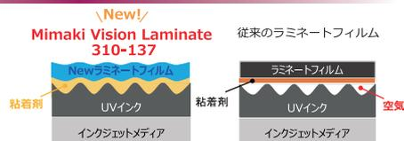
Mimaki Vision Laminator 310-137は、柔らかい接着剤とコシの弱いフィルムを使用しているためUVインクの表面の凹凸に追従しやすく、空気を巻き込みにくいです。
