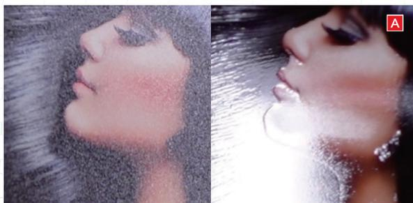
右がカラーグロス機能でプリントしたサンプル。グロス感が分かりやすいように、光を当てて写真撮影している。左は通常のUVプリント。カラーインクだけでグロス仕上げができるので、クリアインクの節約になる。UVライトの照射量を調整することで実現した。インク量が多い箇所ほど、盛り上がり硬化される。
